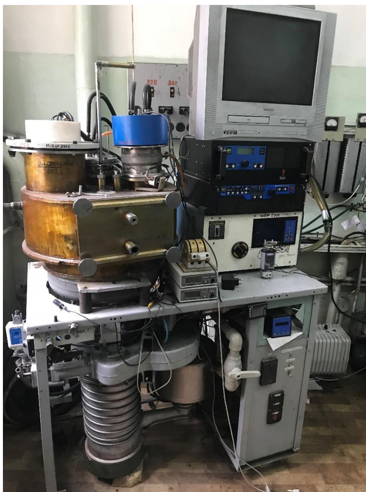
Рисунок 13 – Фотография внешнего вида укомплектованной установки реактивного магнетронного распыления
